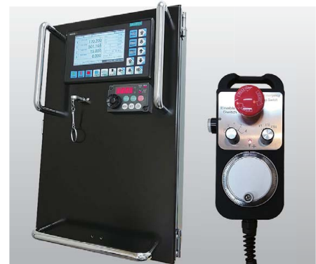
新型メインコントローラ & 手動パルスコントローラ USBメモリで加工データを取り込みます。
